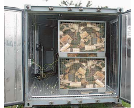
Standardgitterboxen für 1 srm Scheitholz im Containertrockner.
