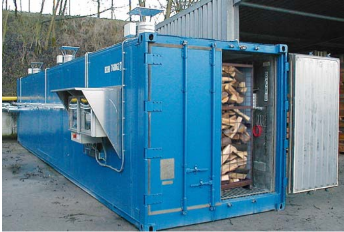
Standardgitterboxen für 1 srm Scheitholz im Containertrockner.
