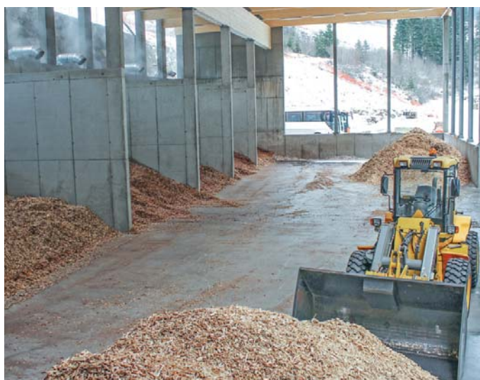
Aufbau der Unterkonstruktion bzw. Wände der Trocknungsboxen mit Holz, Beton oder Stahl möglich
